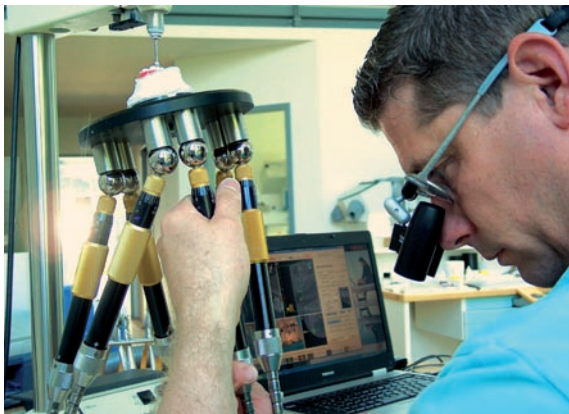
Abb. 5: Mit dem Positionierer X1med3D wird die Röntgenschablone mittels computer-generierter Bohranweisung zur Bohrschablone umgearbeitet.
